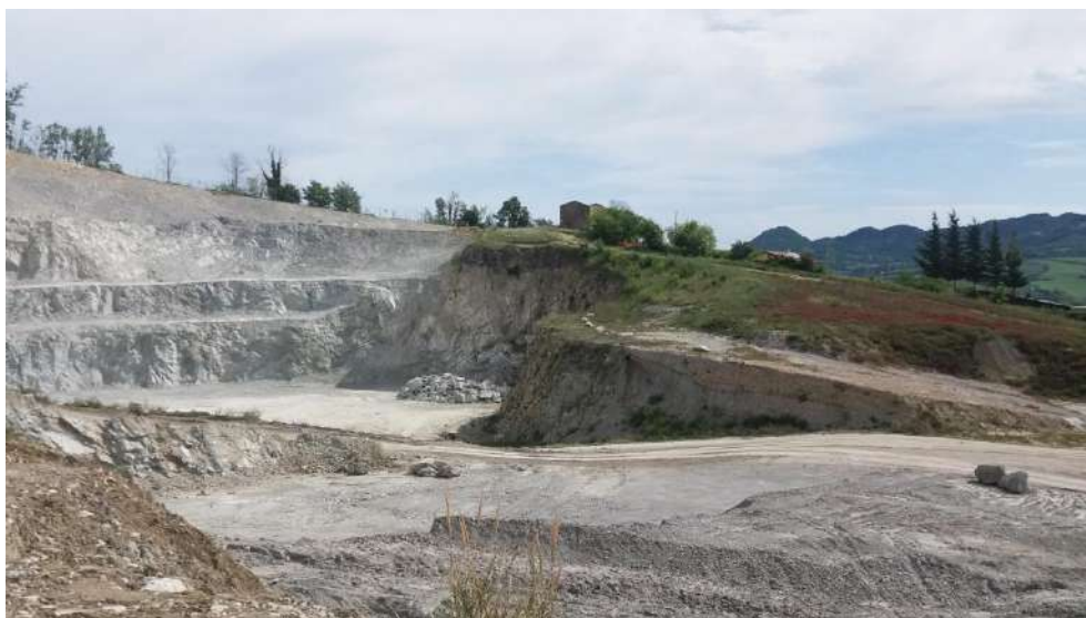
Foto 8 – fronte cava attivo nel settore Est dell’ambito SMN2-1 Case Monti. L’attività estrattiva futura sarà attuata con approfondimento della trincea di base attualmente presente nella zona estrattiva attiva.
