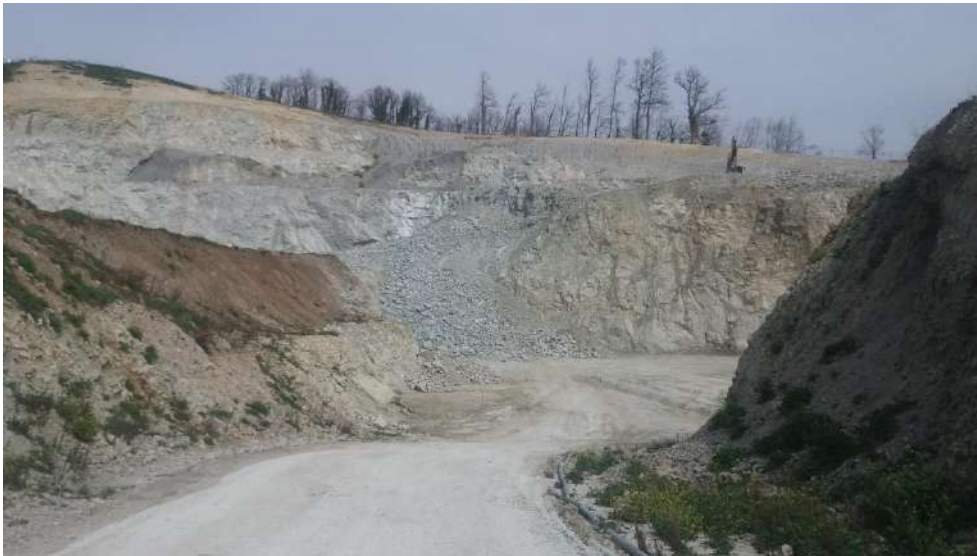
Foto 1 – UMI con attività estrattiva in corso. Sullo sfondo il fronte cava attuale; sulla destra e sulla sinistra in primo piano i conglomerati in parte pliocenici ed in parte della Formazione di Acquaviva. L'estrazione futura sarà attuata approfondendo il piano di base attuale.
