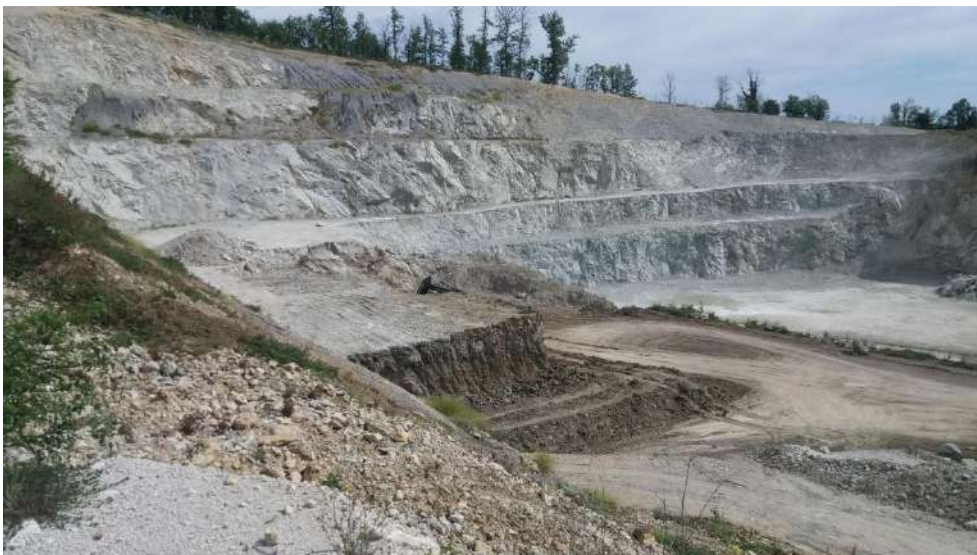
Foto 2 – Panoramica del fronte cava in attività. Sullo sfondo le gradonature nel calcare della Formazione di San Marino; al centro nella foto una zona con materiali sterili in fase di rimozione. I cappellacci rimossi vengono contestualmente ricollocati nella contermina UMI in corso di sistemazione finale.
