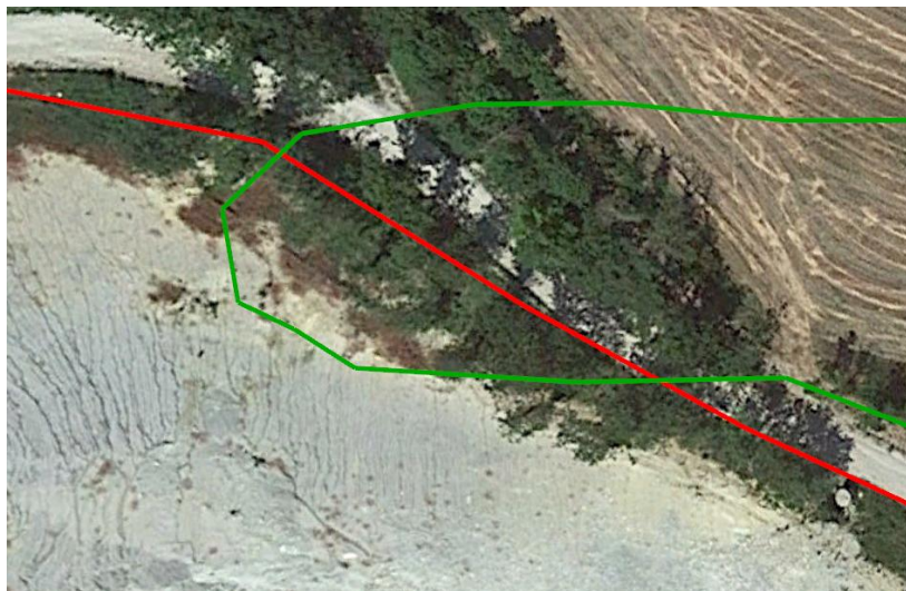
Fig. 27 – dettaglio della foto precedente. Lembo della copertura detrito di versante da verificare al margine Nord. Si evidenzia lo scavo che ha di fatto eliminato la copertura già nelle passate fasi estrattive.
