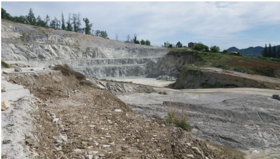
Fig. 19 – fronte cava attuale: sulla destra il contatto con le arenarie plioceniche, al centro e sulla sinistra il fronte gradonato che contorna lo scavo in trincea.
