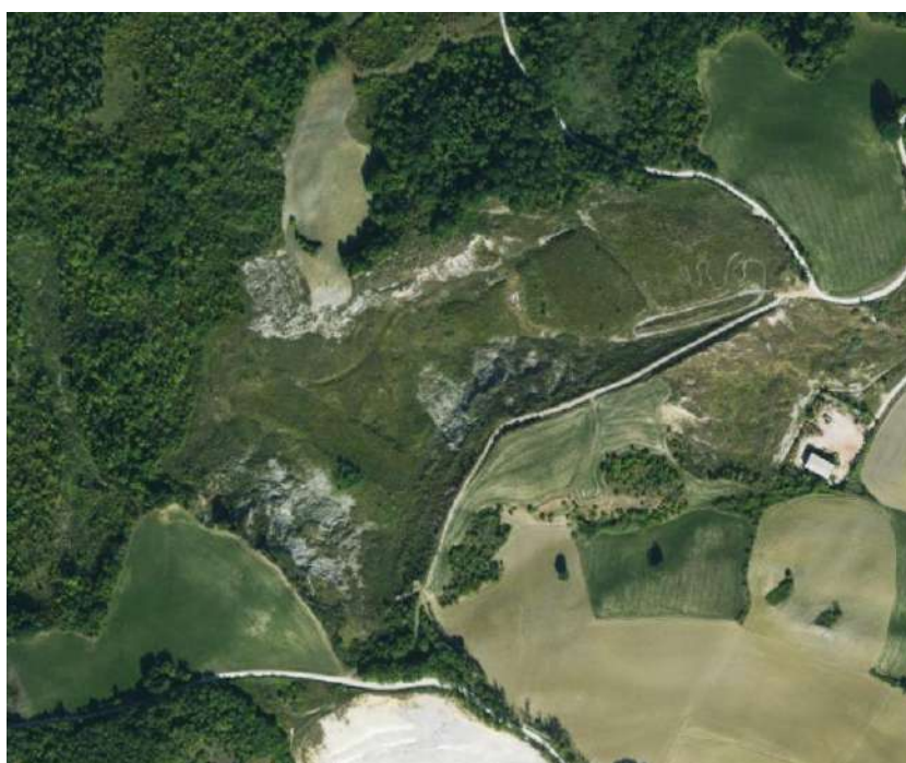
Foto. 12 - Ortofoto RER 2018. La foto rappresenta lo stato di fatto del sito. Si nota una generale rinaturalizzazione soprattutto nel confronto con l'immagine precedente. Sono visibili anche i dissesti (per colamento) lungo il margine sud ed ovest del fronte di scavo.
