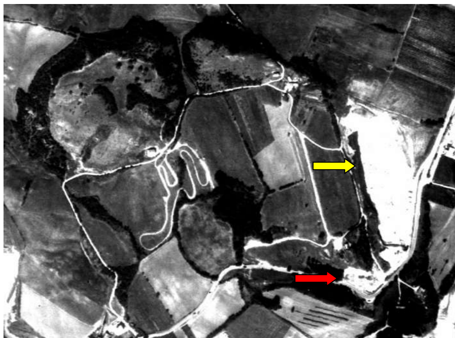
Foto 1 – Ortofotopiano Regione Marche del 1978. Il sito estrattivo era concentrato lungo la SP 258, nella posizione dell'attuale "Giardino Roccioso" (ancora non in trincea) indicato con freccia gialla e a ridosso della sede stradale con freccia rossa (cfr foto seguente). Le zone più ad ovest non erano ancora interessate da attività estrattiva
